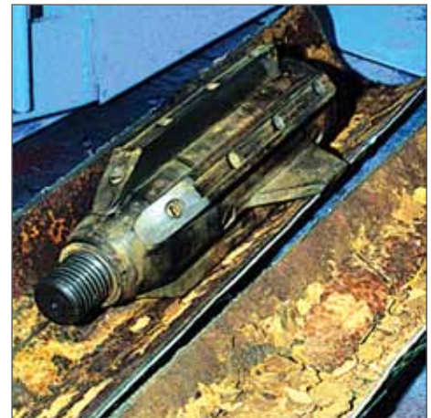
Рис. 2. Расширитель со сменными ножами. Набор инструмента включает расширители, сменные ножи, резьбовые адаптеры, головки для производства прокола.
